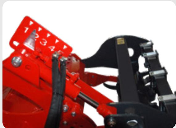
Parallelogramma per combinata con seminatrice MultiDrill
