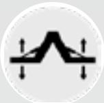
La posizione fissa degli erpici rotanti pieghevoli Vigolo può essere optionalmente modificata in flottante tramite la rimozione di un fermo meccanico. Attraverso dei cilindri idraulici abbinati ad una camera a sistema tuffante, i due corpi macchina assumono una posizione diversa che si adatta alla conformazione collinare o sconnessa del suolo.
