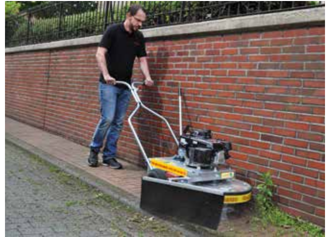
Zwadvormer/ spat bescherming kan zonder gereedschap worden gemonteerd.
